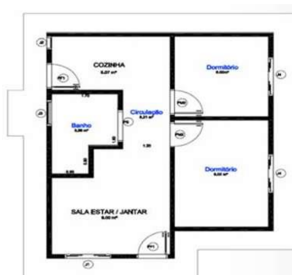
Figura 21: Planta Tipologia B – Área: 38,64 m 2 Fonte: Empresa 3
